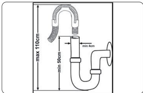
Conecte el tubo de desagüe de agua directamente en el agujero de desagüe o en el grifo de salida del fregadero. Esta conexión debe estar como mínimo a 50 cm y como máximo a 110 cm del plano del suelo.
