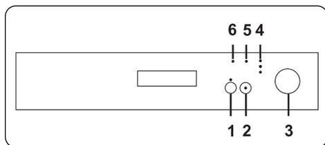
Gire el Selector de Programa (3) para encender la máquina y seleccionar el programa adecuado para sus platos. Cuando el selector está en la posición 'OFF', la máquina no funciona.
