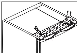
5. Coloque el cobertor superior en el congelador. Ajuste los 2 tornillos en la parte posterior del cobertor superior.
