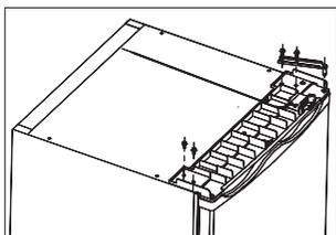
3. Levante la puerta y colóquela en una la superficie acolchonada para que no se raye. Quite ambas patas ajustables y el soporte de la bisagra inferior desatornillando los pernos. Luego, trasládelos al otro lado.
