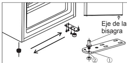
4. Coloque la puerta en el nuevo lugar asegurándose que el pasador ingrese en el buje de la sección del bastidor inferior. Reemplace la tapa al colocar el centro de la bisagra superior en el orificio de la puerta superior asegurándola con 2 tornillos. Reemplace los otros 2 tornillos al otro lado.
