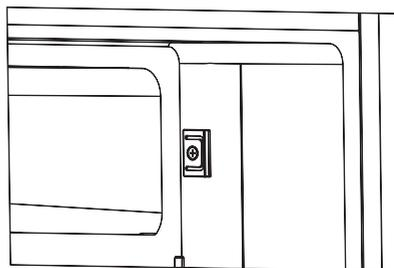
4. Gire la puerta del compartimiento del congelador a 180°, cubra la tapa en el soporte de la puerta superior. Luego, coloque la puerta en el orificio del eje de la puerta superior.
