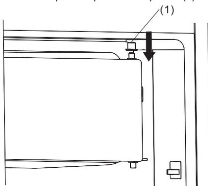
3. Utilizando un destornillador, retire la guía de instalación y luego, colóquela en el lado opuesto.
