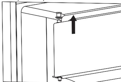
5. Mantenga la puerta del compartimiento del congelador cerrada. Fije el botón de instalación en el soporte inferior de la puerta. Presione el botón de instalación para que no haya ninguna espacio con la cavidad y luego fije el tornillo.
