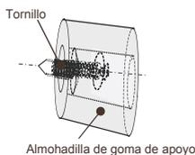
3. Alinee el tornillo con el orificio en la cubierta de la base inferior. Ajuste la almohadilla a la cubierta de manera firme con un destornillador de estrella (auto proporcionado).
