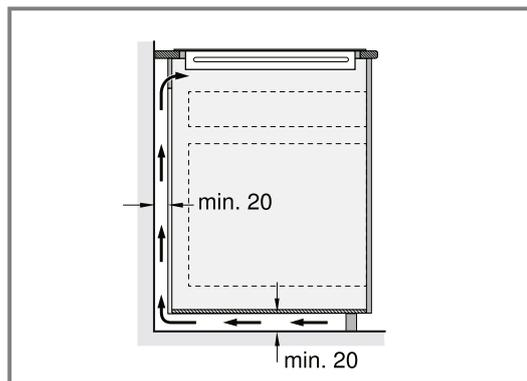
2. Una abertura en la parte superior de la pared trasera del mueble.
