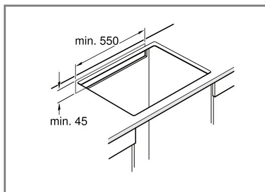
3. En el caso de no tener una separación mínima de 20 mm en la parte trasera del mueble, se deberá realizar una abertura en la parte inferior del mismo.
