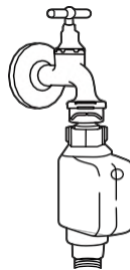
Mangueira de abastecimento de segurança
